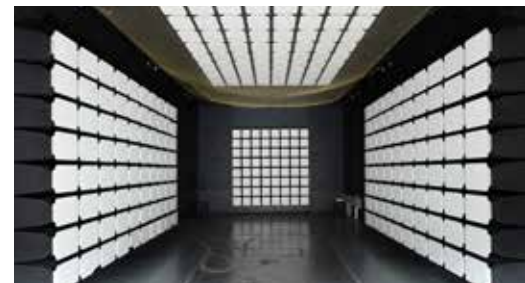
Chambre semi-anéchoïque CEM de Sopemea Trappes dimensions : 18m x 8m x 6m
