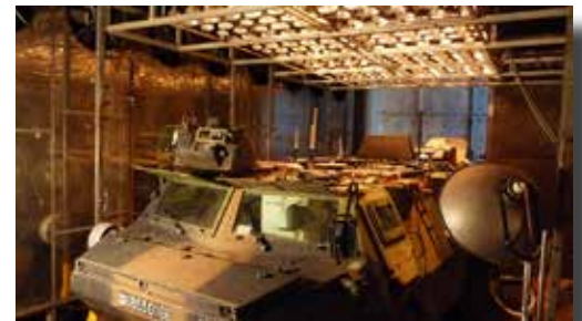
Essai de rayonnement réalisé par Sopemea Vélizy sur un véhicule militaire dans une enceinte climatique de 200 m 3
