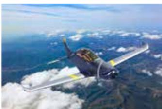
SMD SAS est une entreprise spécialisée dans la conception et la fabrication d'aéronefs légers à turbopropulseurs. Notre premier modèle, le HF1.1 « Faucon Hobereau » est un avion léger biplace en tandem, équipé d'un turbopropulseur de 250 CV, spécialement destiné à la formation initiale des pilotes des forces armées.
